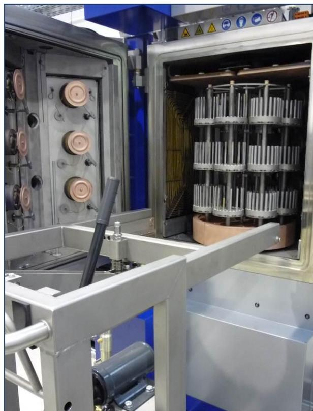
Благодаря магнитному полю, генерируемому дуговым источником типа ARC, создается меньшее количество макрочастиц. Результат воспринимается визуально в виде слоя насыщенного бриллиантового цвета. В зависимости от задач, стоящих перед клиентом, возможно комплекция установки источником распыления, или дуговым источником типа ARC квадратной формы, например, для декоративных применений.
